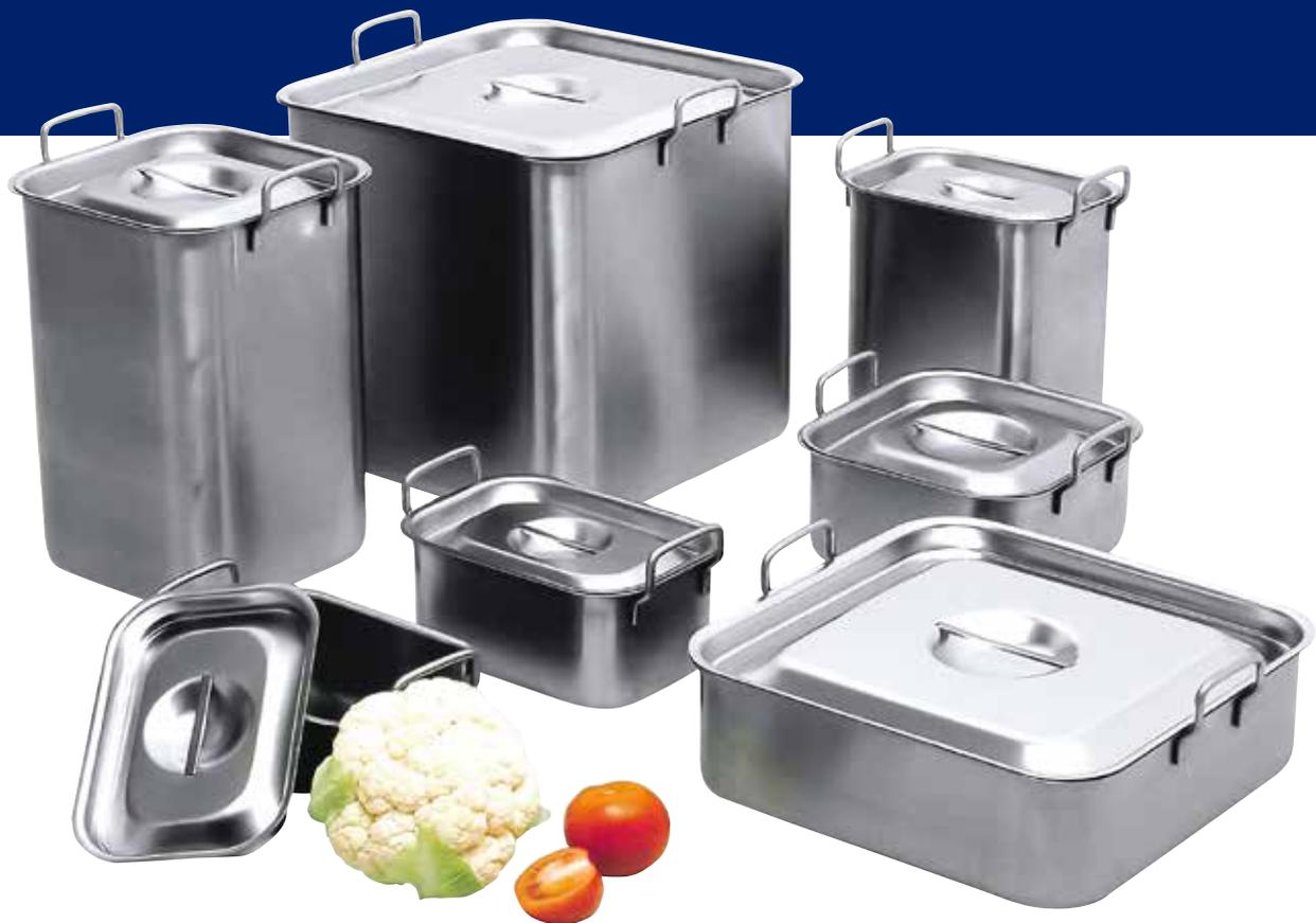
ABC-Schalen werden aus hochwertigem 18/8-Edelstahl hergestellt, dessen Oberfläche aufgrund der elektrolytischen Politur so fein ist, dass sie in puncto Hygiene höchsten Ansprüchen gerecht wird. Sie erfüllen die europäische Norm EN 631 für Materialanforderungen beim Umgang mit Lebensmitteln. Durch die Plattenstärke von 0,8–1 mm ist eine lange Lebensdauer gewährleistet.
